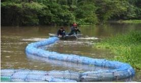
La Nicabarda es una trampa artesanal de botellas plásticas vacías amarradas entre sí, y en el centro se coloca una con arena o agua para estabilizar el engranaje y sirve para retener y confinar el arrastre de residuos y desechos sólidos que son arrastrados sobre la superficie del agua.
