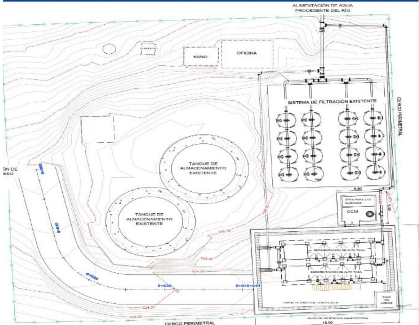
**PLANTA DE CONJUNTO FLOCULADOR - SEDIMENTADOR**
